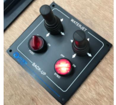
Wenn der Kontrollstick direkt in Richtung Steuerbord gedrückt wird, dann wird die Steerdüse das Schiff nach Steuerbord fahren. Wenn der Kontrollstick in Richtung Backbord gedrückt wird, dann wird die Steerdüse das Schiff nach Backbord fahren. Der Kontrollstick ist eine Ein-Aus-Steuerung. Für zunehmende Bewegung den Kontrollstick kurz betätigen.
